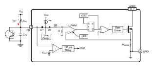
Figure 21. OLP Circuit
