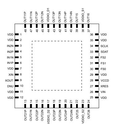
Figure 22. 48-Pin QFN Pinout
