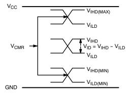
Figure 8. V<sub>CMR</sub> Diagram
